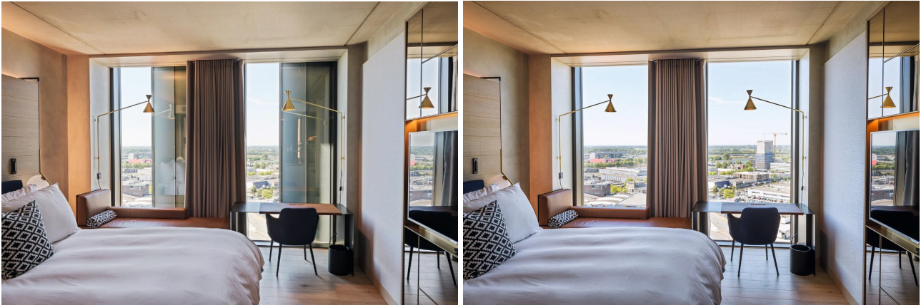
Abbildungen 3 und 4: Solange der Gast nicht in seinem Zimmer ist, werden die Schiebeelemente vor der geschosshohen Verglasung je nach Witterung automatisch geschlossen oder geöffnet. (Quelle: HUECK)
